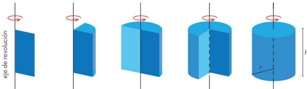
El cilindro resultante tiene un radio igual a la medida de la base del paralelogramo usado y su altura coincide con la medida del otro lado, paralelo al eje de rotación.
