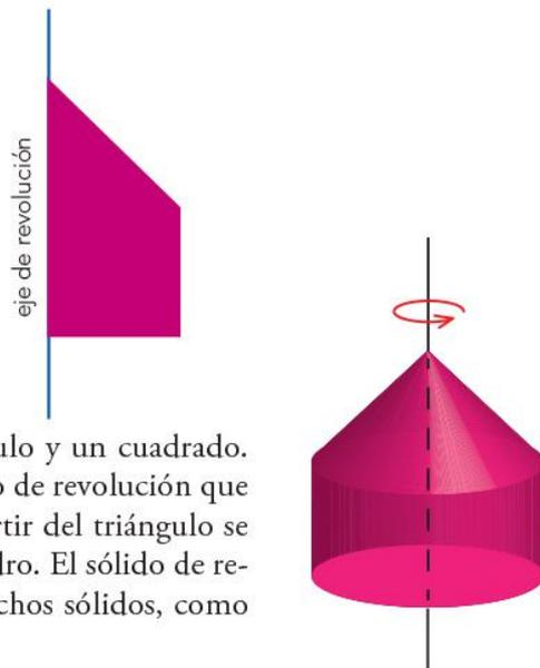
La figura plana está compuesta por un triángulo y un cuadrado. Esta información sirve para identificar el sólido de revolución que se obtiene con cada figura por separado. A partir del triángulo se obtiene un cono y el cuadrado genera un cilindro. El sólido de revolución resultante es una combinación de dichos sólidos, como se muestra en la figura.
