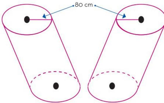
Los cilindros están inclinados pero, debido al principio de Cavalieri, se recurre directamente a la fórmula de volumen de un cilindro cuya altura representará la distancia del piso al techo. Es conveniente utilizar el metro como unidad porque el volumen está en metros cúbicos.
