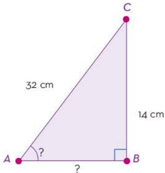
Para resolver el problema, como primer paso se analizan los datos presentados en el triángulo: la hipotenusa mide 32 cm y el cateto opuesto, 14 cm. Con esta información se identifica qué razón aplicar para obtener la medida del  $\sphericalangle A$ ; en este caso es el seno.
